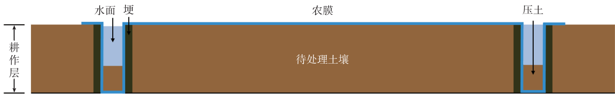
图 1 土壤强还原处理覆膜示意图
